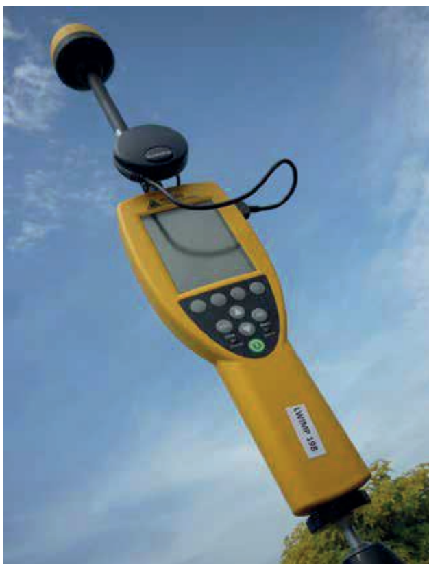
Miernik natężenia pola elektromagnetycznego Narda NBM-550 z sondą EF-0391 (fot. arch. WIOŚ Gdańsk)
